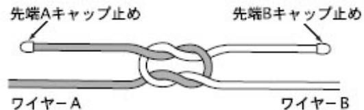
2) 結び目をねじってAの先端をB側のワイヤーに、Bの先端をA側のワイヤーに向ける。
