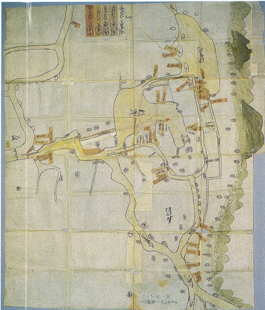
▲堤切所付箋図（貞享四年） 延宝年間に発生した旧大和川の洪水と堤防決壊箇所を発生年月により付箋の色を変えて示した絵図面。堤防の復旧や排水路の開削など大和川改善工事の実施を訴えた訴状の付図。 中 好幸 氏所蔵。
