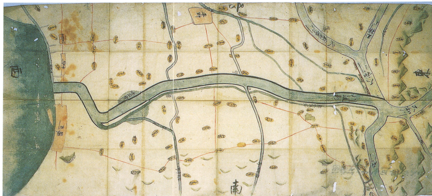
▲川違え新川図（年不祥） 新大和川と落堀川開削、大乘川切り替え、東除川流入、西除川切り替え、十三間堀川延長などの付帯工事を示した絵図。他に紀州街道に架かる大和橋を描いたものも遺る。 中 好幸 氏所蔵。
